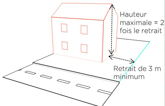
Ces règles ne s'appliquent pas aux éléments de modénature de façades ou de toitures limités tels que les attiques, loggia, balcons, garde-corps, retraits et débords, ponctuels, lucarnes, cheminées, bandeaux, garde-corps, etc., ainsi qu'aux extensions et annexes inférieures chacune à 25 m<sup>2</sup> d'emprise au sol et à 3,5 m de haut.
